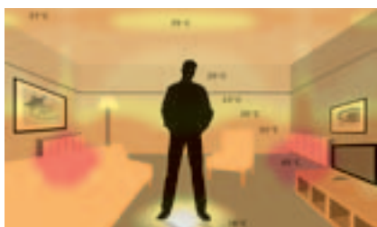
Hagyományos fűtési modell (fűtőtestek) Eredmény: nagy hőmérséklet-különbségek a helységben (18°C és 65°C között).
